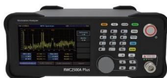
设备可高精度实时解调 AM/FM (单声道和立体声)，可测试载波功率、频率偏差、AM 调幅度、FM 频偏及导频信号相关参数。设备支持实时输出解调后的音频信号。设备可配置音频发生功能，可输出基带音频信号，支持左右声道电平和频率的独立设置，同时具备数字（平衡）及模拟（平衡及非平衡）音频输出接口。设备具有音频分析功能，可分析解调后的基带音频信号，支持频域和时域分析，可显示音频的频谱和波形。RWC2500A Plus 基于多功能的组合可直接分析广播发射机的关键指标。例如：载波参数、音频失真度、音频信噪比、音频频率响应和立体声音频分离度等，单台仪器实现发射机的指标测试，从而满足广电行业广播发射机的完整测试。
